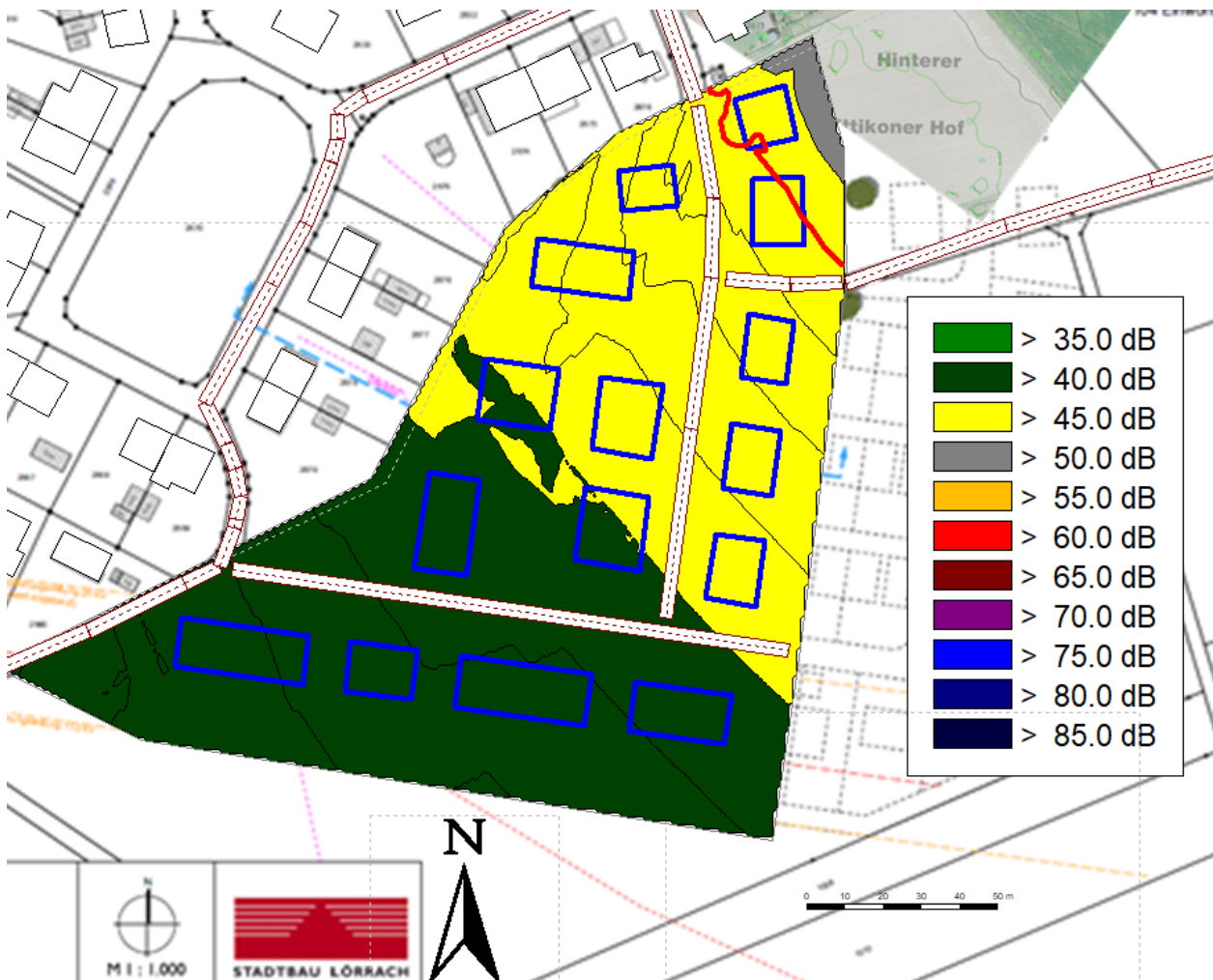
Abbildung 4: Rasterlärmkarte Verkehr nachts in einer Höhe von h = 5\text{ m}
