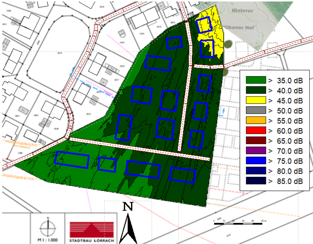
Abbildung 10: Rasterlärmkarte Gewerbe tags (mit Schallschutzmaßnahmen)
