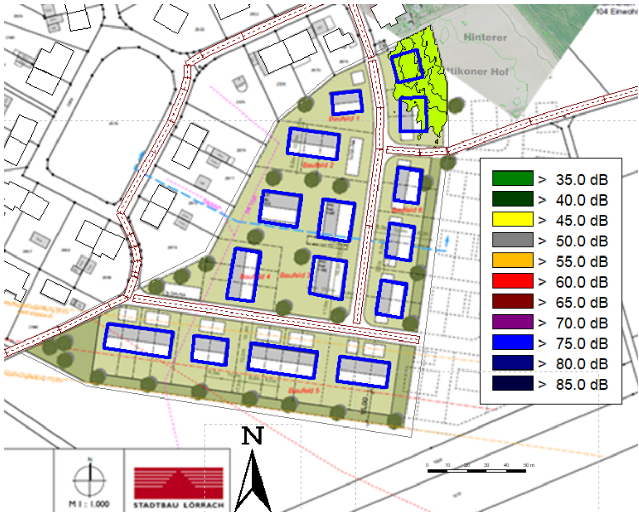
Abbildung 11: Rasterlärmkarte Gewerbe nachts (mit Schallschutzmaßnahmen)
