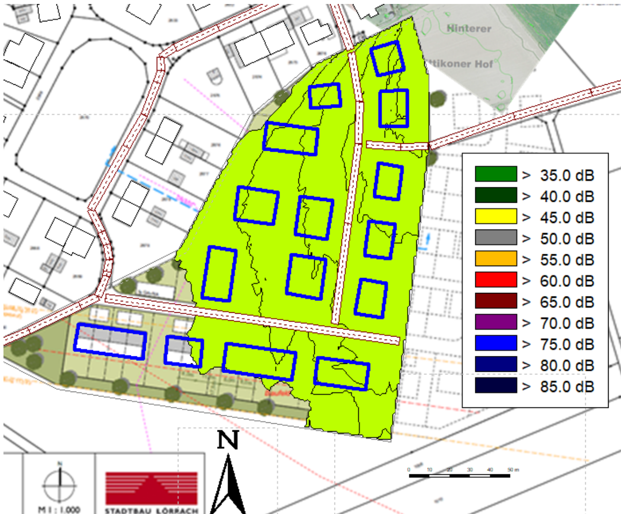
Abbildung 6: Rasterlärmkarte Gewerbe nachts in einer Höhe von h = 4\text{ m}
