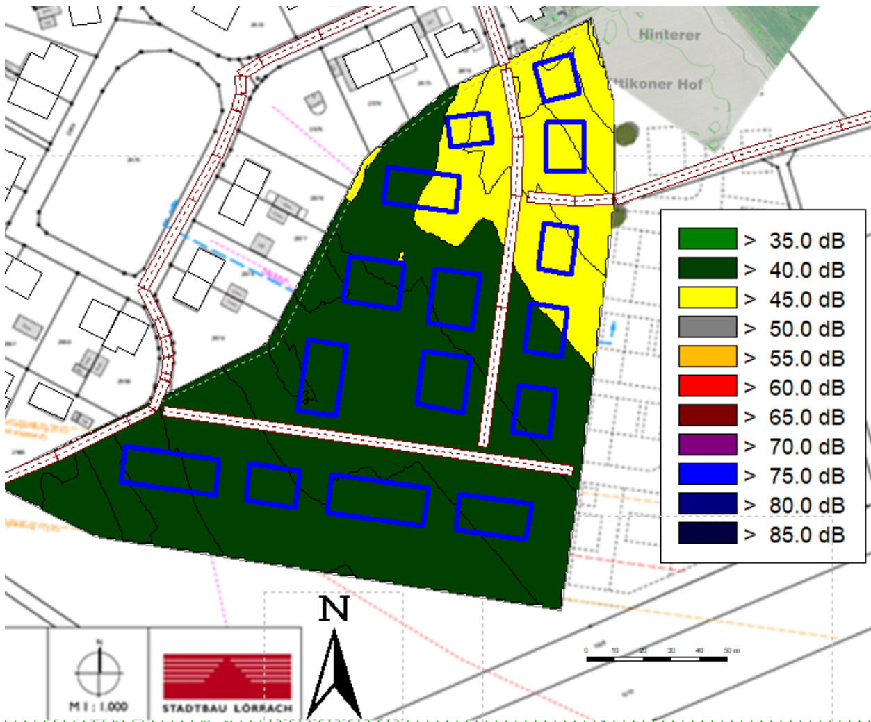
Abbildung 9: Rasterlärmkarte Straßenverkehr nachts (mit Schallschutzmaßnahmen)
